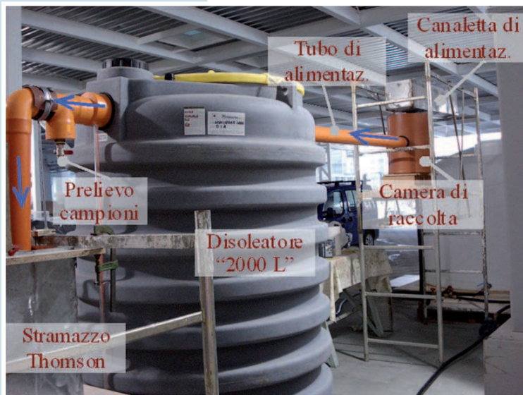
Figura 1 – Disoleatore monostadio “2000 L” di Diliberto e banco di prova
