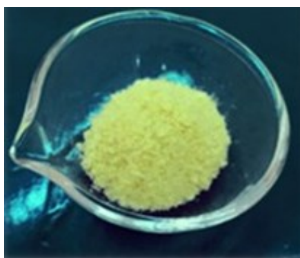
Figura 58. Aspetto della polvere di BioQ-CPX ottenuta dopo il processo di freeze-drying
