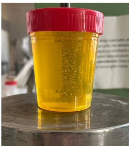
Figura 40. aspetto della soluzione in diclorometano costituita da PCL e CUR
