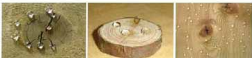
Figg. 9.2 – Legno trattato con rivestimenti idrofobici
