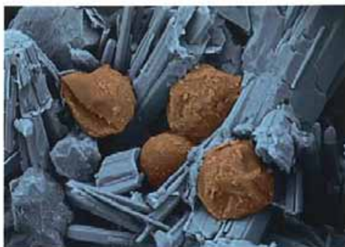
Fig. 10.11 – Un'immagine al microscopio di Micronal PCM della BASF
