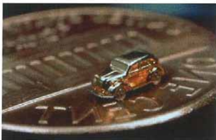
Fig. 3.3 – Microcar realizzata dalla Nippondenso. L'ultimo modello ha un micromotore di 1 millimetro di diametro, alimentata elettricamente da un filo di rame di 25 micron
