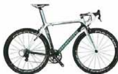
Fig. 3.20 – Bicicletta realizzata in fibra di carbonio unidirezionale, con i processi di produzione più avanzate, tra cui le nanotecnologie (ditta produttrice: Bianchi)
