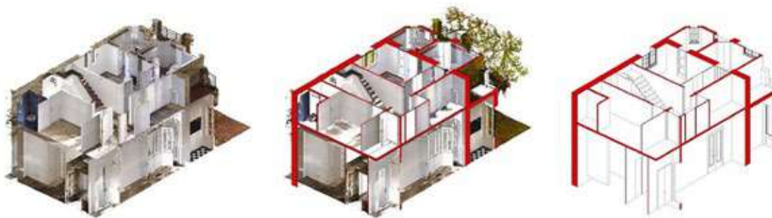
Fig. 4. Scan to BIM. Da sinistra: nuvola di punti; sovrapposizione nuvola di punti e modello BIM; modello BIM.
