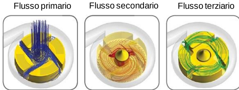
Fig. 2.1 Analisi fluidodinamica in un cuore artificiale che evidenzia i flussi che si generano al suo interno
