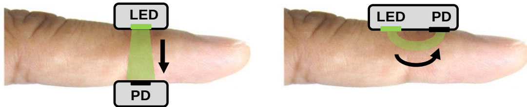
Fig. 4.4 È possibile osservare la configurazione a trasmissione a sinistra e a riflessione a destra
