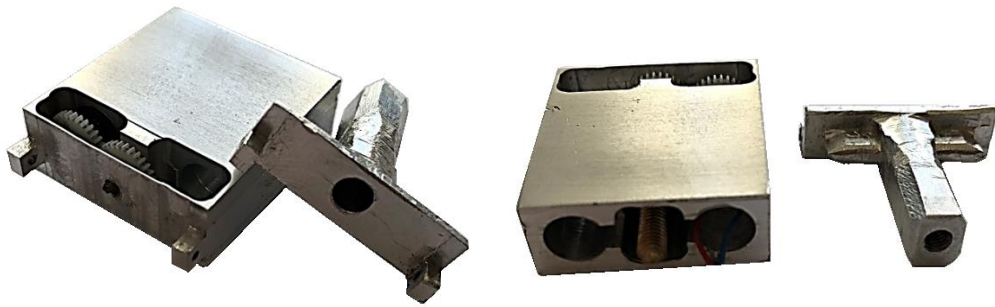
Cassa e carrello disaccoppiati e realizzati con una fresatrice. (Dimensioni della cassa= 26 x 24 x 9 mm)
