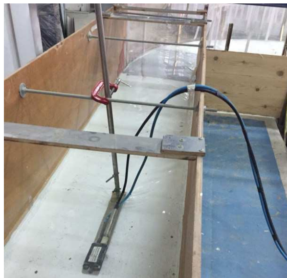
Fig. 4.1: Immagine del misuratore di portata, collocato dentro il canale rettilineo di invito
