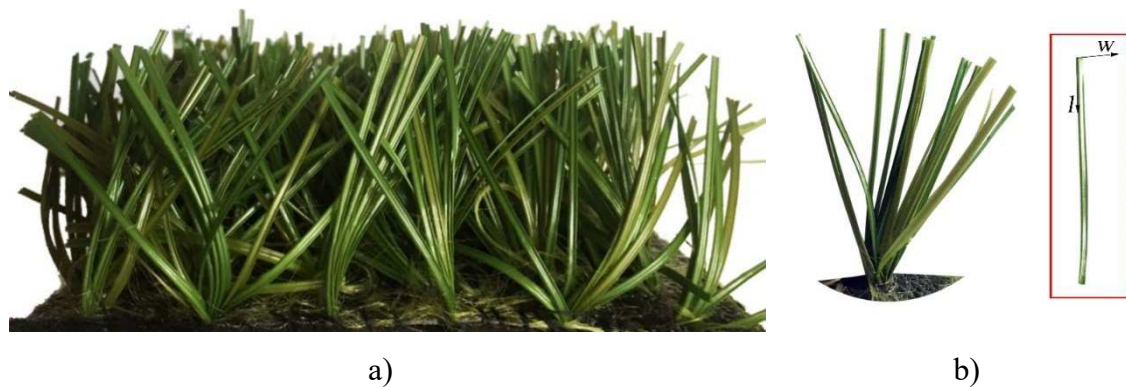
Fig.3.3: Vegetazione artificiale utilizzata per le prove: a) foto del campione; b) foto del singolo cespuglio con indicazione degli assi di riferimento del singolo stelo
