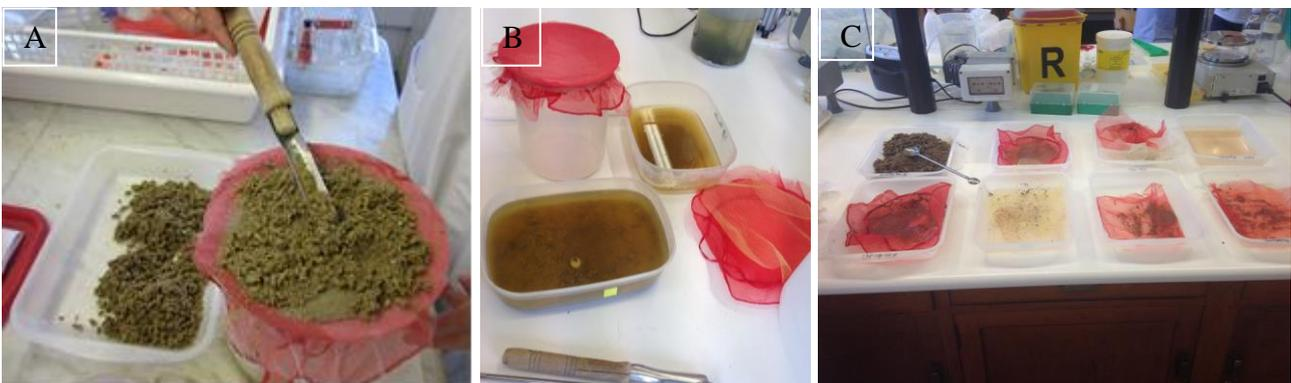
Fig. 24 – Fasi di setacciatura: (A) ricontrollo sabbia sgranellata al microscopio, (B) controllo sabbia fine depositata sui tubi di plastica, (C) lavaggio con alcool etilico di maglie utilizzate come setaccio durante il sorting.
