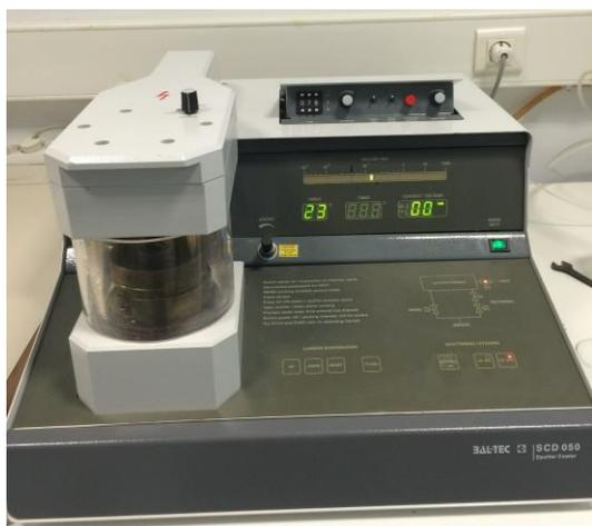
Fig. 28 – Strumento per ricopertura metallica dei campioni (Baltec SCD 050)
