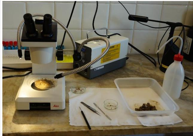
Fig. 23 – Strumentazione da laboratorio utile alla estrazione degli individui di dimensioni non visibili ad occhio nudo
