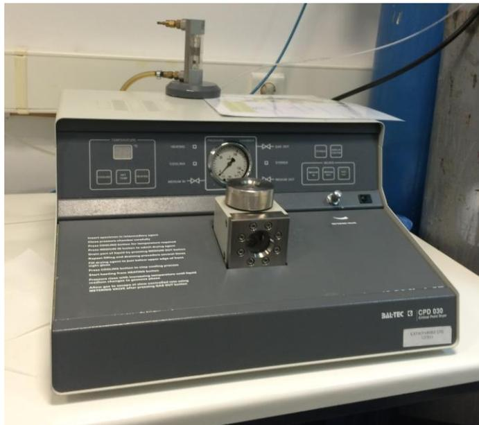
Fig. 27 – Strumento per essiccazione dei campioni (BAL-TEC CPD 030)
