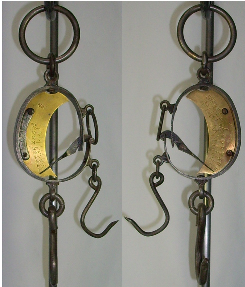
Figura 2.6: Bilancia meccanica modello Mancur: (sinistra) portata di 20 kg, (destra) portata di 150 kg.
