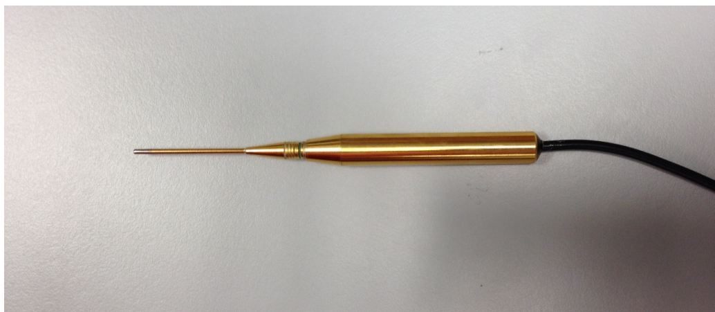
Fig. 21 Idrofono needle; punta da 1 mm e preamplificatore
