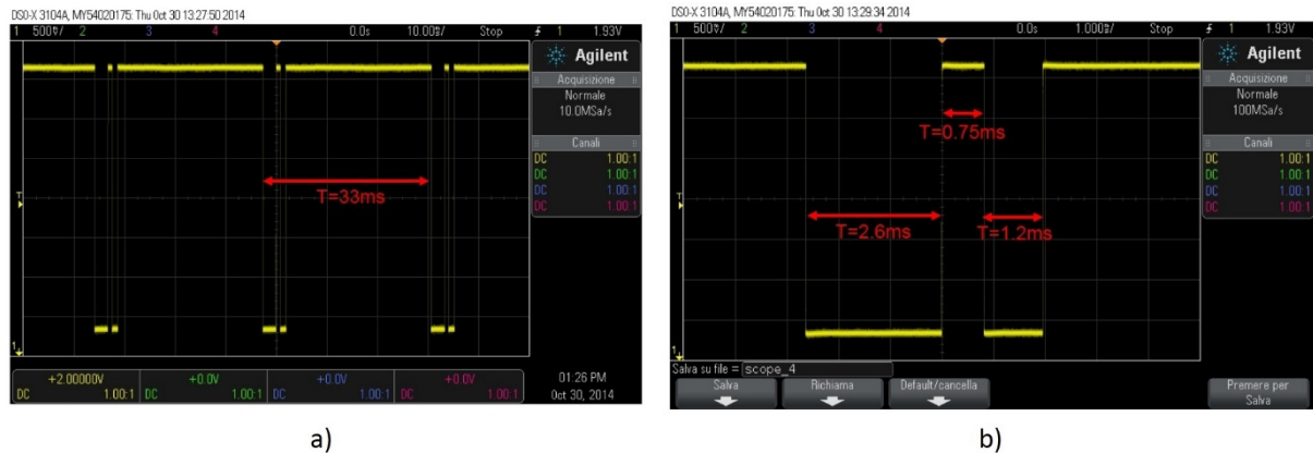
Fig. 15 Segnale di blanking a) con T_r 33 ms e zoom b) degli impulsi negativi
