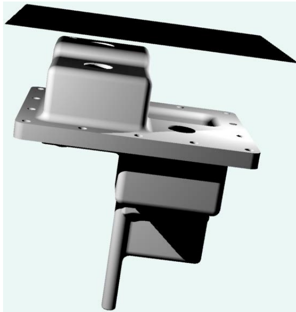
Fig. 49 Visione prospettica del progetto CAD per la stampa 3D dell'holder
