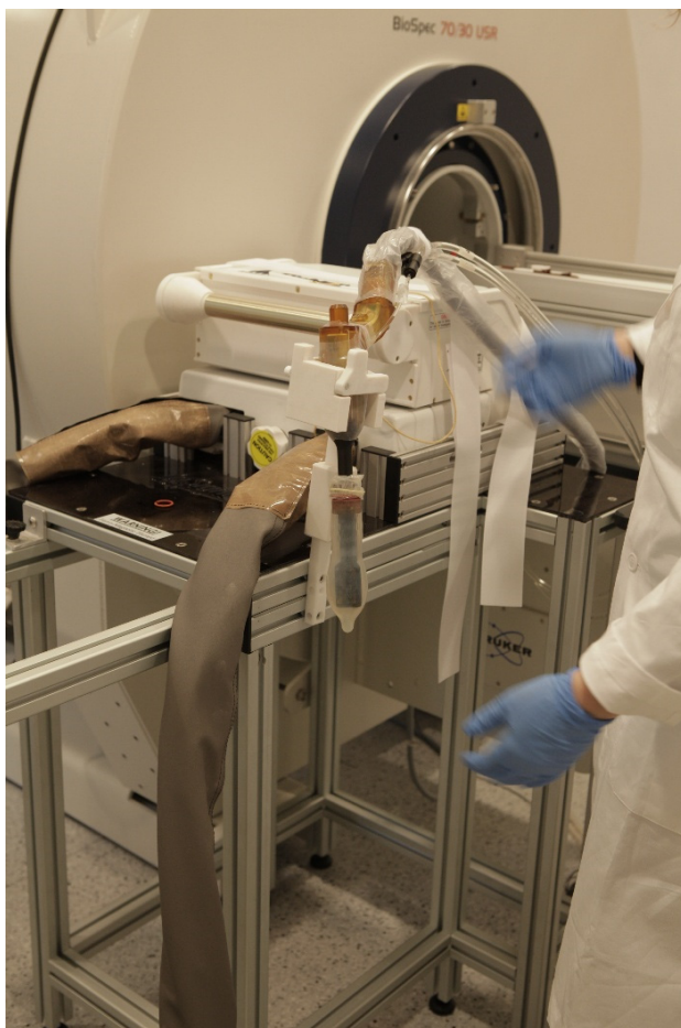
Fig. 13 Craddle FUS modificato – vista posteriore
