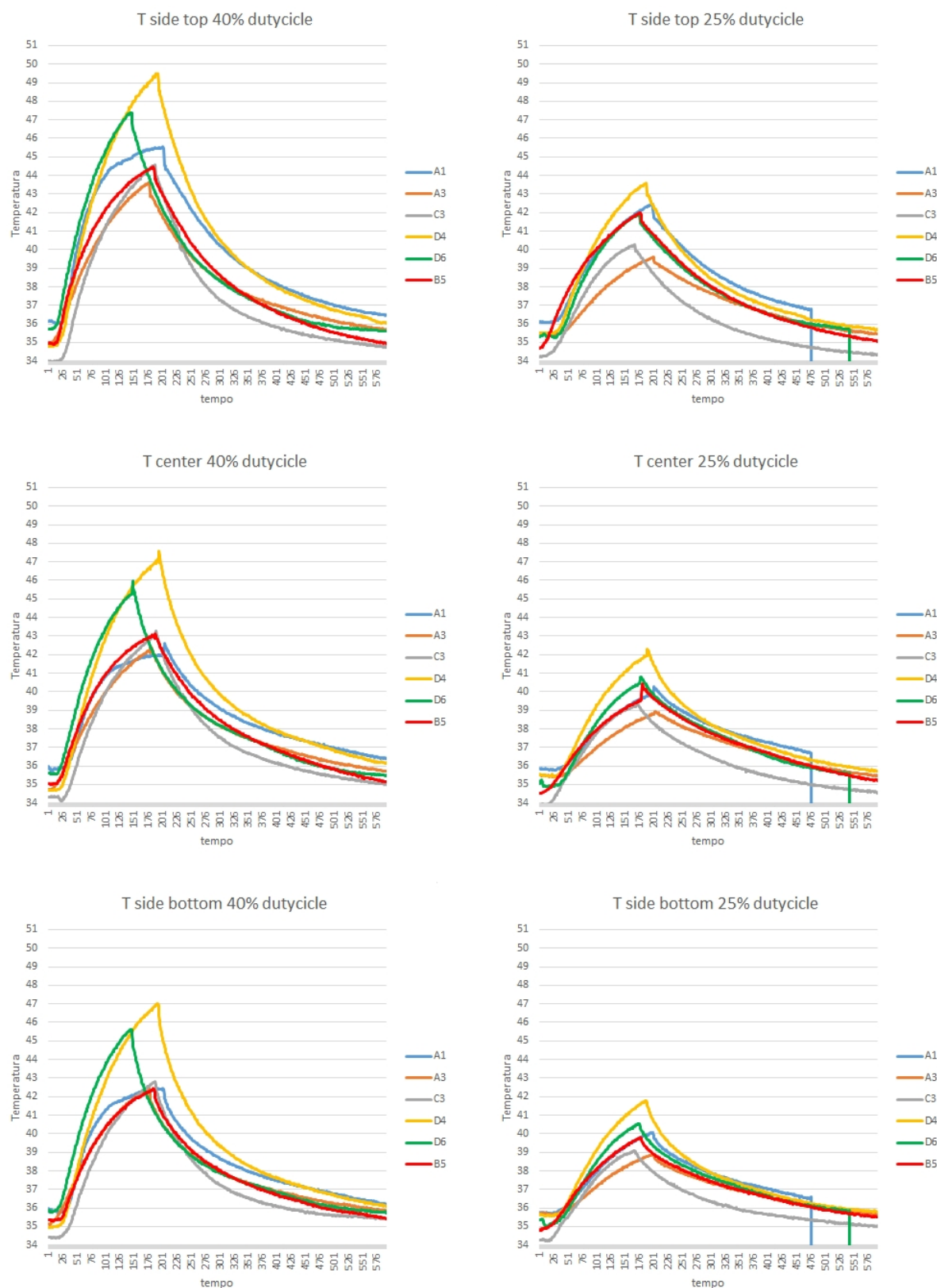
Fig. 57 Grafici delle temperature rilevate dalla termocoppie; sulla sinistra sono mostrati i risultati ottenuti con il 40% di duty cycle, sulla destra i valori delle stesse termocoppie con il 25% di duty cycle
